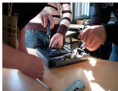
Démontage d'un DEEE
